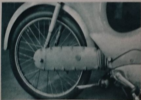
2 Kettenkasten mit Ölfüllung, gleichzeitig als rechter Schwingerarm — und das Öl ist zugleich Getriebeöl! Nicht nur in dieser Beziehung stellt das Heinkel-Moped in der zunächst gegebenen Gewichtsgrenze eine optimale Lösung dar.
