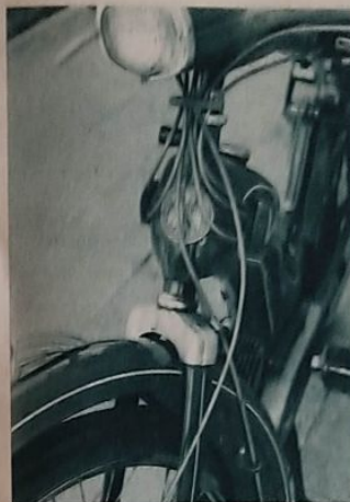
3 Wenn schon viele freilegende Kabel und Bowdenzüge, dann bitte so saubere Ölenführung wie hier bei Victoria.
