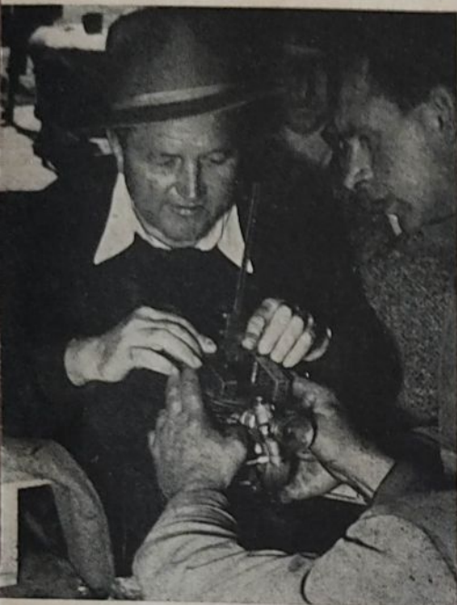
Der 50-ccm-Motor wird von Peter Peregrin auf Hub und Bohrung nachgemessen. Da der Kolben mit seiner Krone über den oberen Zylinderflansch hinausreicht, sind Parallelmasse auf den Flansch gesetzt. Der 16-mm-Bing-Vergaser ist deutlich zu erkennen. Foto: Nickl
