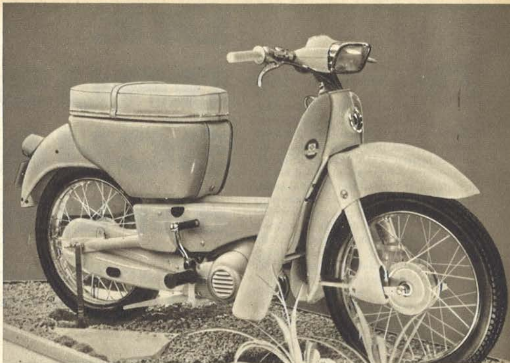
Oben: Der 50-ccm-Motor mit Kühlgebläse hat viele angeregt, sich mit der Idee eines Kleinrollers zu befassen. Dabei fand das rationell arbeitende Hercules-Werk mit dem Modell 222 die beste Lösung in der Form eines Kleinstfahrzeuges, das Motorrad- und Roller-Merkmale vereint. Dieses praktische Fahrzeug ist preiswert; es kostet DM 920.—.
