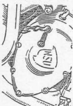
Antriebsgehäuse mit Motorenöl\*) an der vordersten Schraube des Antriebsgehäusedeckels mit einer Spritzkanne nachfüllen. — Kontrolle wie beim Schmieren des Getriebes. **Einfüllmenge 0,1 Liter.**
